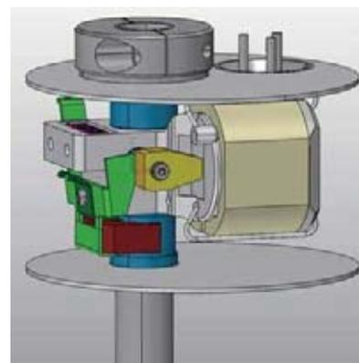
**UQK6200** 系列浮筒液位开关工作原理是基于浮筒系在一根与弹簧连接的不锈钢缆索上,其浮筒自重总是大于测量介质所产生的浮筒浮力,因此弹簧总是被拉长的,在自由状态下,弹簧被拉伸到预定长度,通过一个不锈钢限位器限制弹簧超出弹性限度。在弹簧的导杆内安放一级磁体,它可以根据弹簧的伸缩变化而在压力管内上下运动。在表壳内压力管的外面安装有一个可上下调整的机械开关。当液面上升淹没浮筒,根据阿基米德浮力定律,浮力增加的量减轻了浮筒的自重,弹簧的弹性减小,弹簧收缩,在上面安放的第一级磁体随之向上运动,磁驱动触碰机械开关通断。当液位下降时,浮筒露出液面,弹簧感知浮筒自重逐渐增加,弹簧长度随之增加,一级磁体的移动使开关复位。
